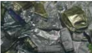
gespreste Aluminium-Verpackung aus der Wertstoffsammlung, bereit zum Zerkleinern und anschließenden Einschmelzen
