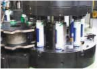
Fertig gerundete und geschweißte Weißblech-Dosen-Körper erhalten unten einen Boden.
